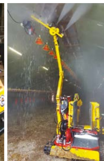
La mécanisation de la tâche assurée par la Lavicole Rabaud apporte un confort à l'utilisateur et permet une meilleure qualité du nettoyage notamment pour les pipettes et les mangeoires.
