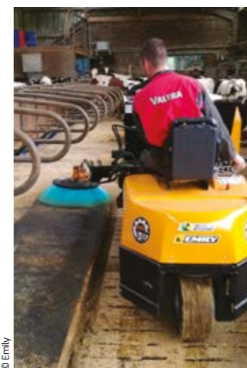
L'automoteur multifonctions conçu par Emily assure en un temps record l'entretien, le paillage, le raclage et le balayage des logettes.
